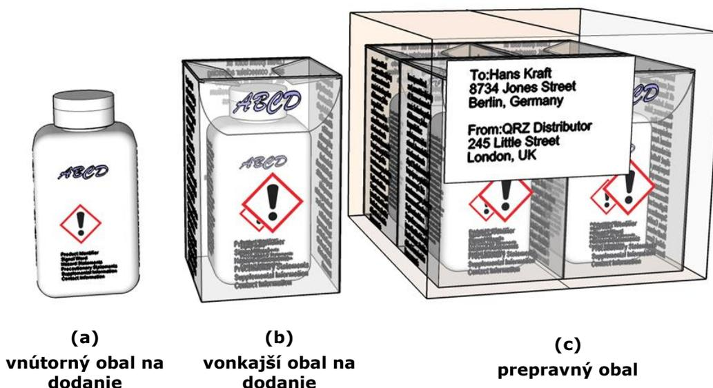
**Obrázok 4: Použitie označovania podľa nariadenia CLP na obal používaný na dodanie a prepravu**
