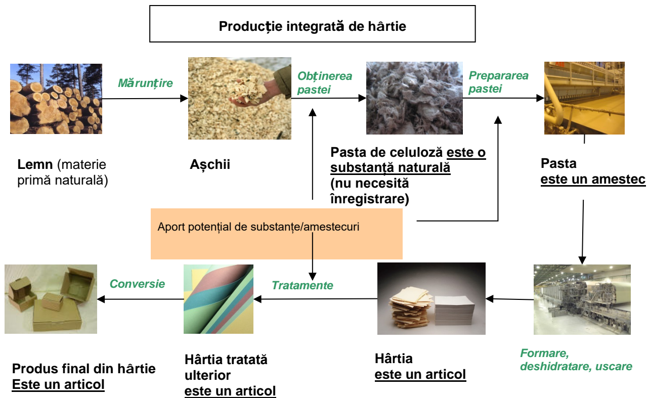
Figura 9: Exemplu ilustrativ pentru punctul general de tranziție de la lemn la articole din hârtie
