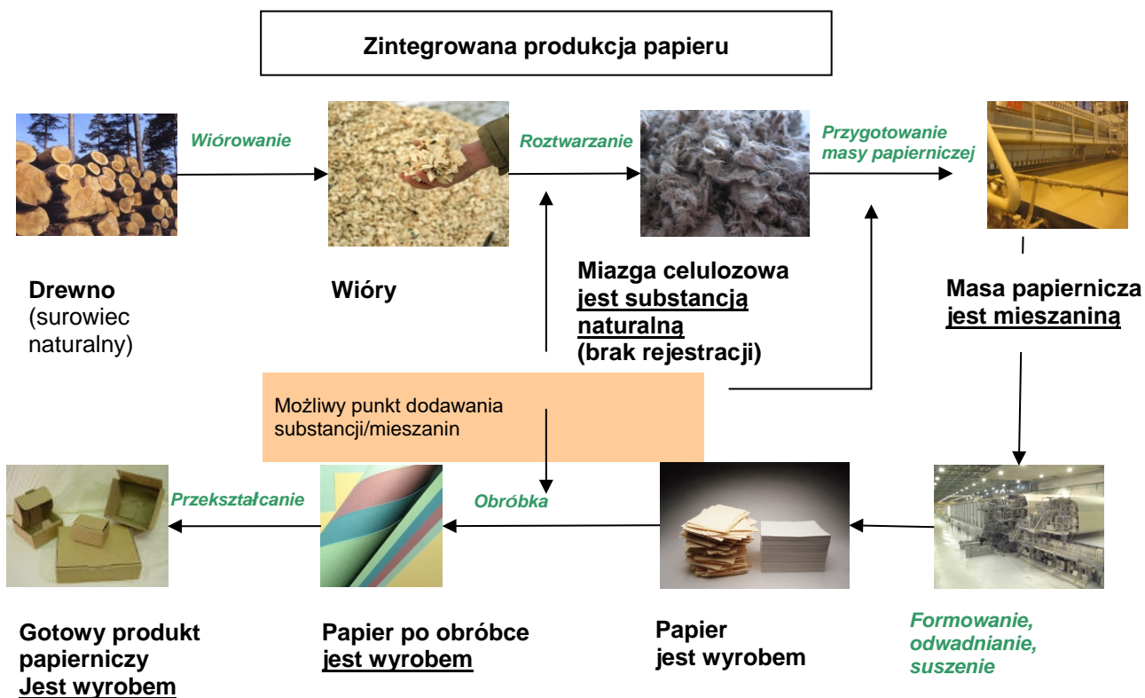
Rysunek 9: Przykład ogólnie ilustrujący przejście od drewna do wyrobów papierowych
